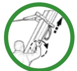
Chariot d'alimentation latérale monté sur roulements avec position fin de travail verticale pour le transport
