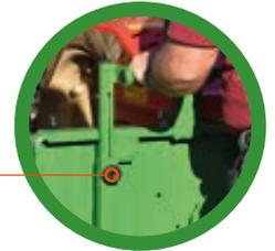
Am unteren Schwenkpunkt der Wippe montierte Pendellager
