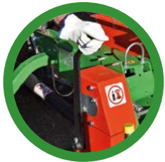
Notbremsvorrichtung des Sägeblattes für Maschinen mit Zapfwellenantrieb
