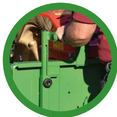
Regolazione altezza impugnatura per avanzamento della bascula
