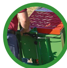
Leva per sblocco avanzamento bascula (Sistema Esclusivo THOR)
