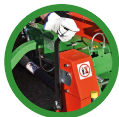
Dispositivo di frenatura di emergenza per modelli con presa di forza
