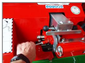
Comando idraulico per la barra di taglio con una leva trattenuta in posizione frontale.
