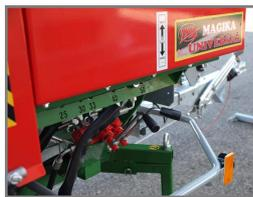
Letture e impostazione misura di taglio. Leve di comando per coltelli idraulici e sollevatronchi.
