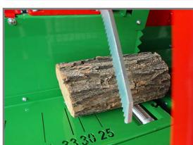
Letture in primo piano per misura di taglio sfrido finale del tronco e pinza idraulica per bloccaggio sicuro durante il taglio.
