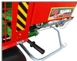
Leva per azionamento manule banco oscillante e ribalta del tronco da spaccare.
